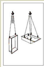
Ящик-контейнер для сыпучих материалов V = 2 \text{ м}^3
