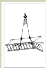
Лестница для спуска в котлован
