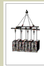
Поддоны с кирпичом
