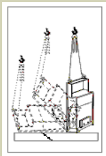
Контейнер для подачи бетона
