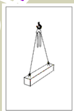
Блок стены подвала
