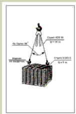
Кирпич на поддонах
