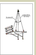
Подмости для бетонирования
