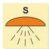
Помещение или группа помещений, защищенных системой пожаротушения для спринклерной системы IMO10.114
