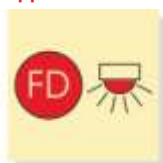
Помещение, защищенное автоматической системой пожарной сигнализацией IMO3.6
