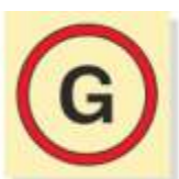
Аварийный источник электроэнергии (генератор) IMO10.116
