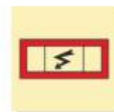
Аварийный распределительный щит IMO3.77
