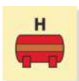
Стационарная установка пожаротушения для др. газа IMO10.72
