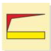
Трубопровод (выпускной) высококатной пены IMO10.87
