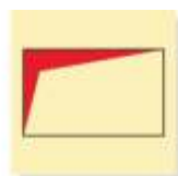
Трубопровод (канал) высократной пены IMO3.74
