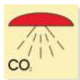
Помещение, защищенное CO 2 IMO3.7
