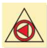
Дистанционное управление аварийным пожарным насосом или пожарным насосом, питаемым от аварийного источника электроэнергии IMO10.49
