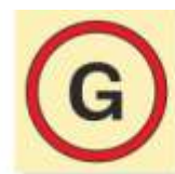
Аварийный генератор IMO3.76
