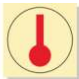
Помещение, контролируемое тепловым извещателем IMO10.124
