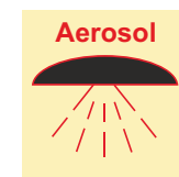
Помещение, защищенное объемным аэрозольным тушением IMO3.91
