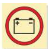
Аварийный источник электроэнергии (батарея) IMO10.117
