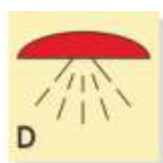
Помещение, защищенное системой водораспыления IMO3.28
