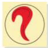
Помещение, контролируемое дымовым извещателем IMO10.123
