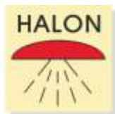
Помещение, защищенное галоном 1301 IMO3.11
